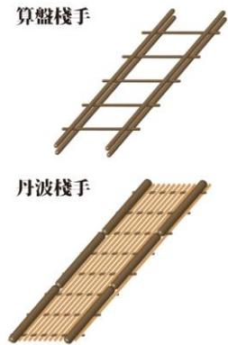
図5 算盤・丹波棧手の模式図
